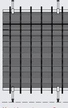
Material: acero inox Área abierta: 44% ø varilla: 2 mm ø cable: 4 x 1 mm Paso cable: 36 mm
