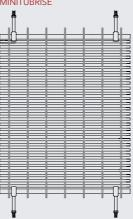
Área abierta: 50% ø tubo: 9 mm ø cable: 3 x 2 mm
