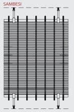
Material: acero inox ø varilla: 3 mm ø cable: 4 x 2 mm Paso cable: 50 mm
