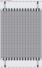
Material: acero inox Área abierta: 44,3% ø cable: 4 x 0,75 mm Paso cable: 26,4 mm
