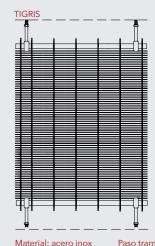
Área abierta: 62,1% ø varilla: 3 mm ø cable: 3 x 2 mm Paso cable: 80 mm
